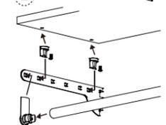
2. 棚受と棚板の鬼目ナットの位置を合わせ、**手回しドライバーで棚板をブラケット(腕木)に同梱のねじで軽く締めて(固定しない)仮止めしてください。**
