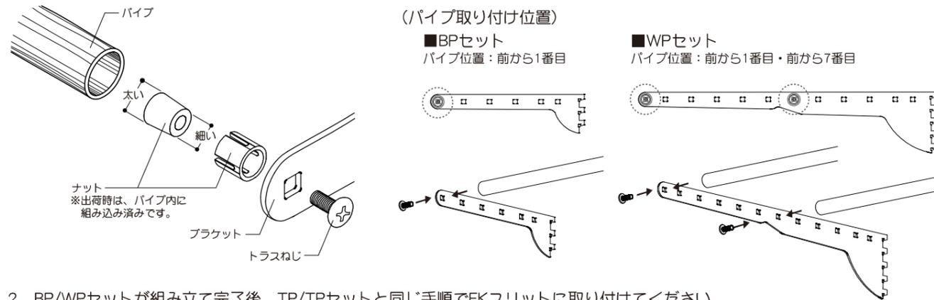
2. BP/WPセットが組み立て完了後、TP/TPセットと同じ手順でFKスリットに取り付けてください。取り付け後、**FKスリットにブラケット(腕木)が確実にハマっているか確認してください。**
