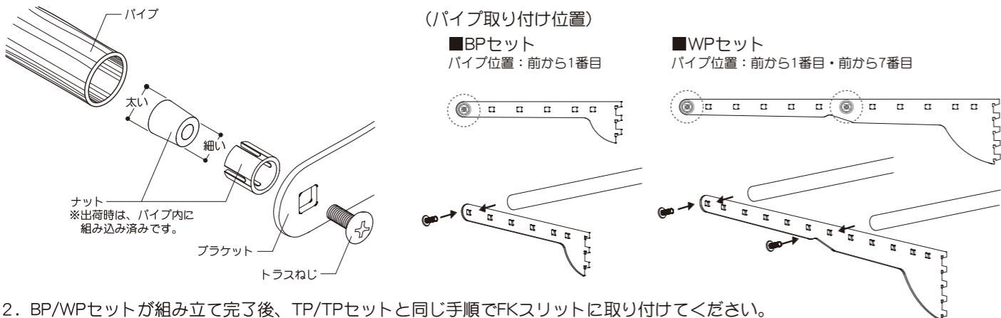
2. BP/WPセットが組み立て完了後、TP/TPセットと同じ手順でFKスリットに取り付けてください。
