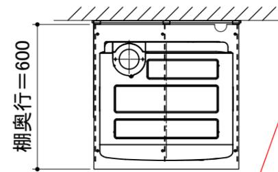
RDT-31Sの防火離隔距離確保のため
