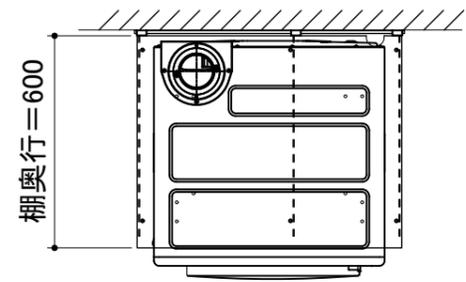
FKレール、水平方向の取付位置は壁際より7.5mm以上のクリアランスを確保してください。
