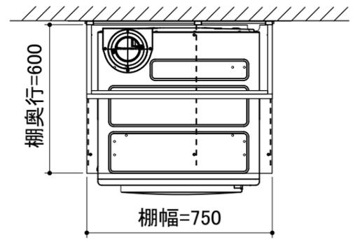
FKレール、水平方向の取付位置は壁際より7.5mm以上のクリアランスを確保してください。
