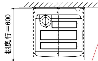
RDT-31Sの防火離隔距離確保のため
